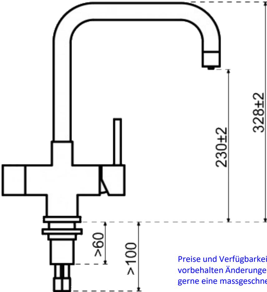
Lochdurchmesser für die Bohrung  $\varnothing$  34 mm
