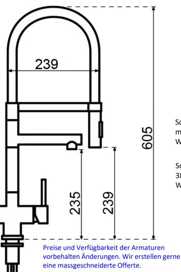
Lochdurchmesser für die Bohrung Ø 34 mm
