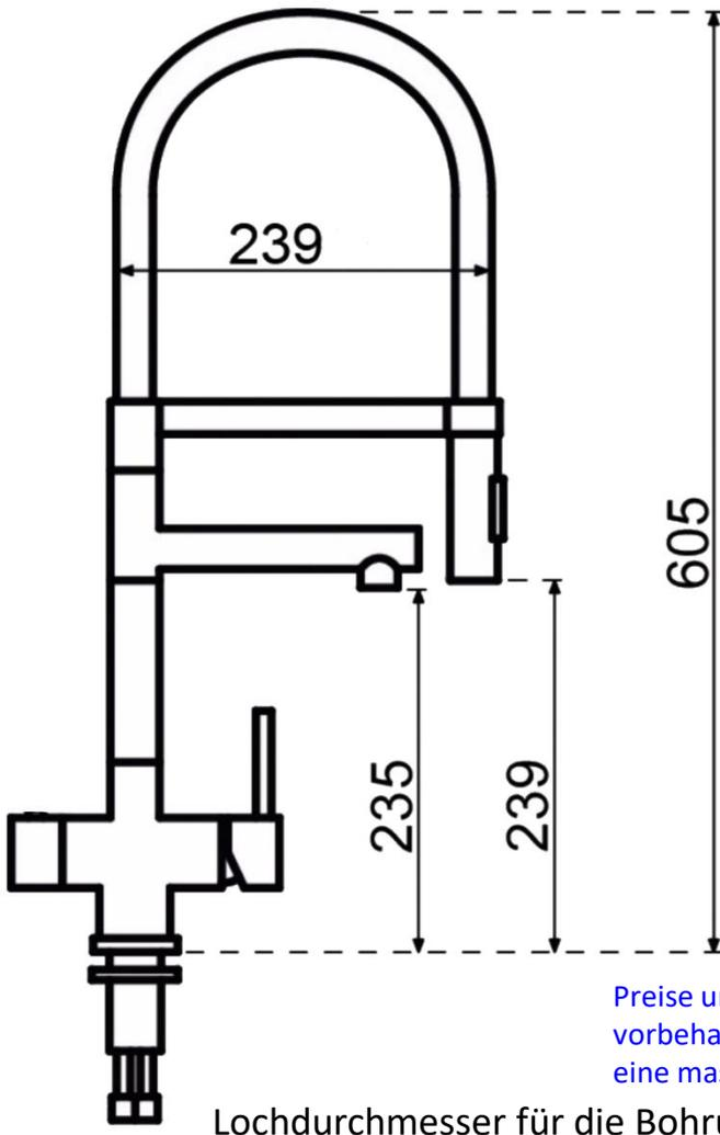
Lochdurchmesser für die Bohrung Ø 34 mm
